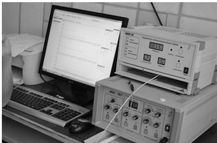
Рисунок 1. Аппаратный комплекс ЛАКК-М для доплеровской флоуметрии с целью изучения состояния периферического кровообращения.
