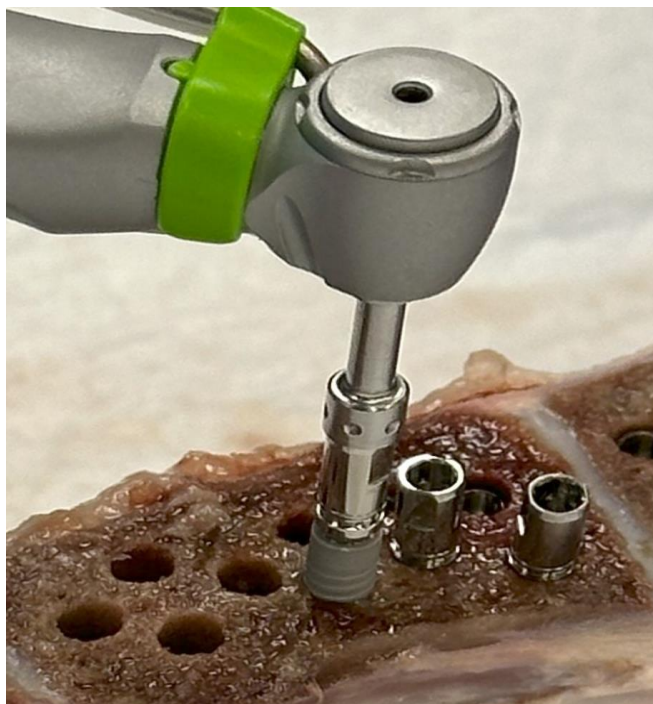
Рис. 14. Установка имплантатов в губчатое вещество грудины свиньи в первой части исследования
