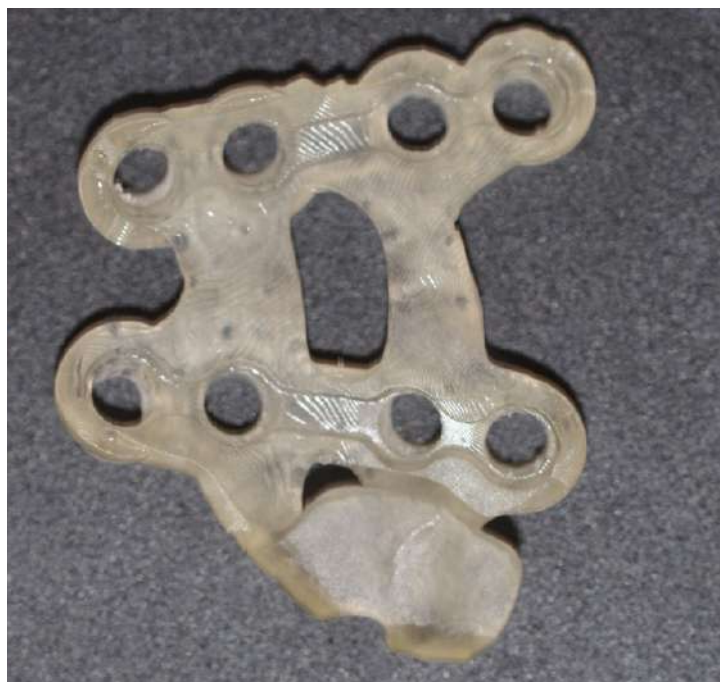
Рисунок 31. Хирургический шаблон изготовлен на 3D принтере.
