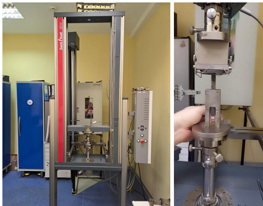
Рисунок 2.6 – Этапы испытаний на сдвиг на универсальной испытательной машине
