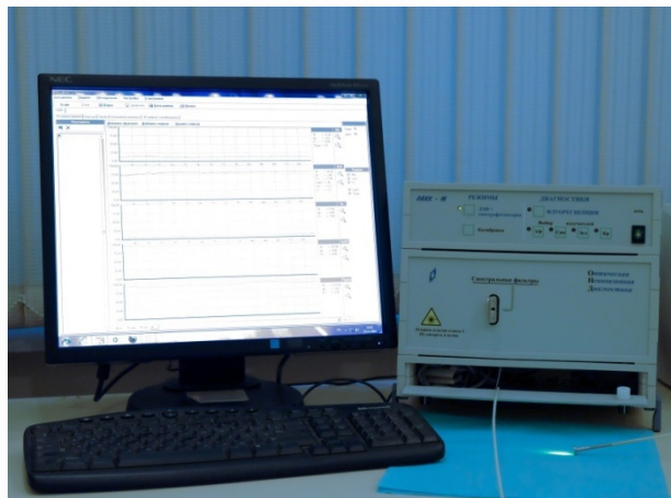
Рисунок 1 - Анализатор тканевого кровотока «ЛАКК-М»
