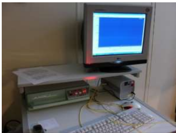
Рисунок 12 - Компьютеризованная спектрально-флюоресцентная диагностическая установка «Спектр-Кластер»
