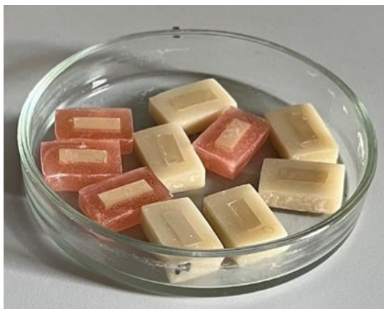
Рисунок 11. Общий вид образцов из диоксида циркония «Ziceram T» фирмы ООО «Циркон Керамика», г. Санкт-Петербург, Россия, подготовленных к исследованию по ГОСТ Р 56924-2016 (ИСО 4049:2009).
