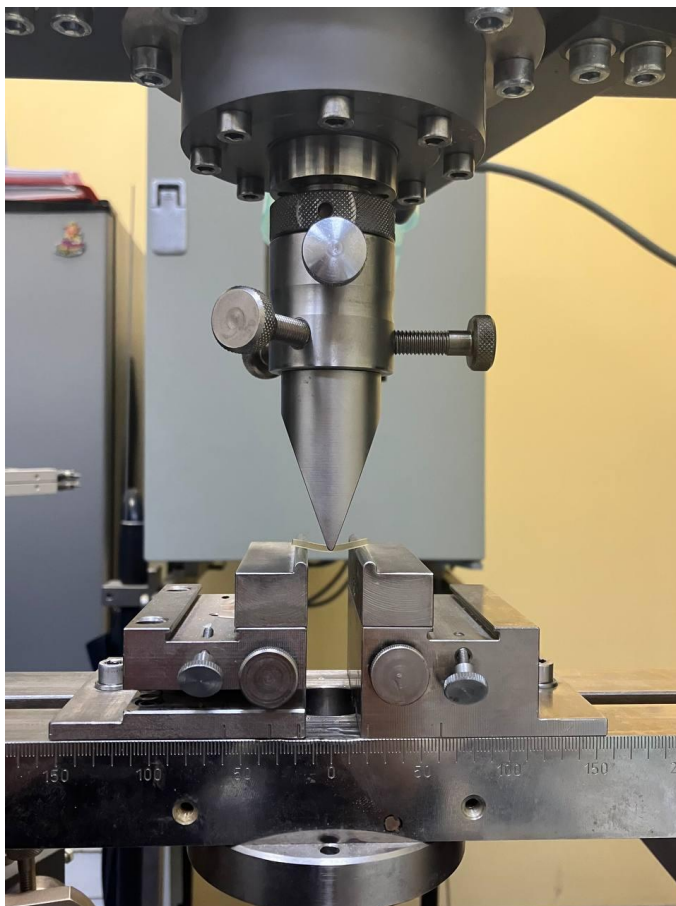
Рисунок 8. Испытательный образец с толщиной слоя 3D-печати 0,05 мм на универсальной испытательной машине Zwick/Roell Z010.
