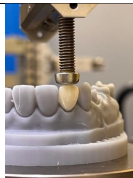
Рисунок 15. Приложение нагрузки к реставрациям на испытательной машине Zwick/Roell Z010
