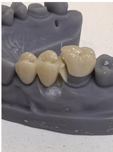
Рисунок 11. Разрушенная мостовидная ортопедическая конструкция в испытательной машине после приложении нагрузки на зуб 15 в мостовидной ортопедической конструкции.
