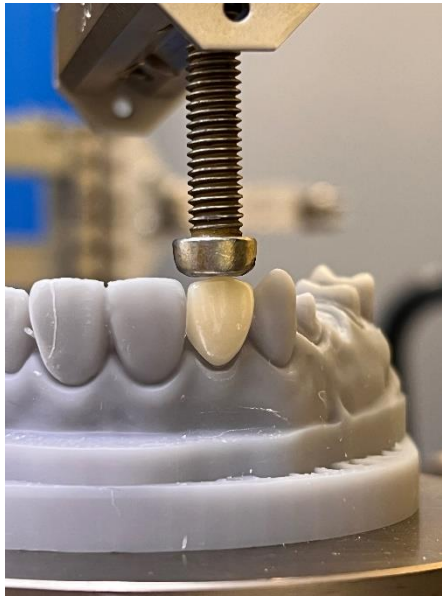
Рисунок 10. Испытание коронки второго резца: приложении нагрузки на режущий край по оси зуба
